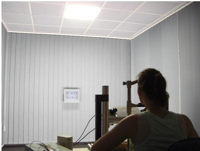
Abbildung 3 – Probandin während Aufgabe 1. Die Probanden rechnen zunächst die beiden Zeilergebnisse aus und subtrahieren anschließend das kleinere vom größeren Ergebnis. Oben im Bild ist die Blendquelle auf eine homogene Leuchtdichte von 8000 \text{ cd/m}^2 eingestellt.
